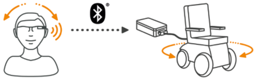
Kopfbewegungen werden von den Sensoren der Brille erkannt und übermitteln Steuerbefehle an das Interface zur Rollstuhlelektronik
